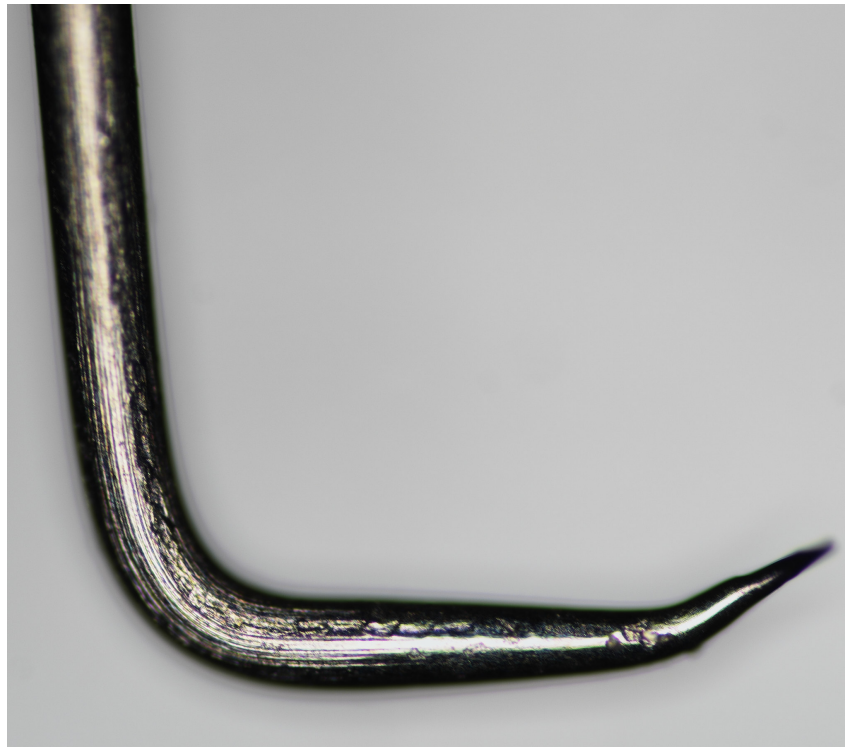
Figure 14: Haken des Pulltesters: Eine vorsichtig vergebogene Messspitze.
